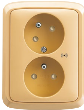
Dvojnásobná zásuvka s natočenou vrchní dutinou, s ochranou před přepětím a akustickou signalizací poruchy
